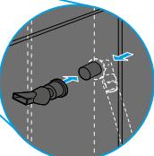
Insérez le connecteur (8) de l'intérieur à travers l'ouverture appropriée, puis installez la buse (9).
